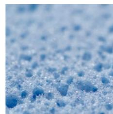
Schiuma ecologica espansa completamente ad acqua nel totale rispetto dell'ambiente senza emissione di gas CFC.
